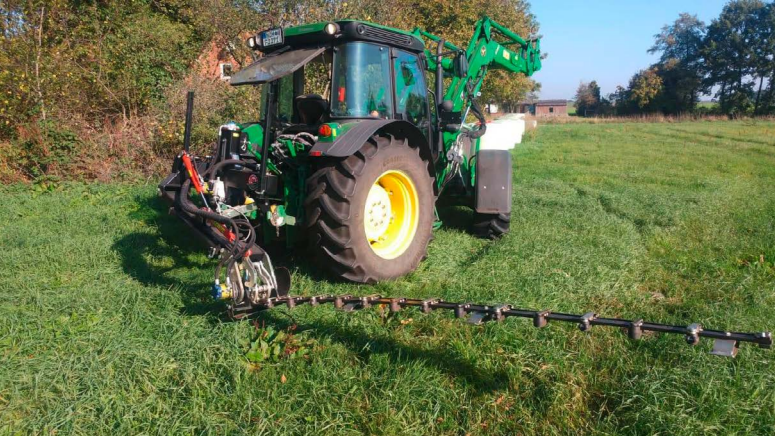
Das Doppelmessermähwerk hat kaum Gewicht und kann mit kleineren Schleppern angetrieben werden, das verringert den Kraftstoffbedarf und den Bodendruck. Foto: Jan Hemmeke
