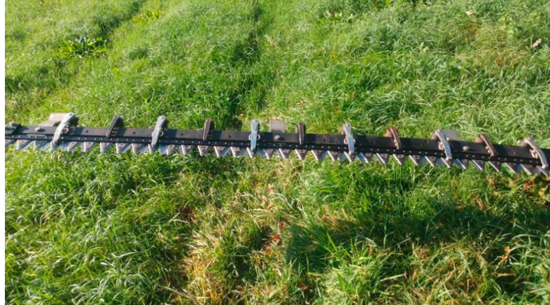
Mit den gegenläufigen Klingen schneidet das Doppelmessermähwerk den Aufwuchs so sauber ab wie eine Schere. Foto: Jan Hemmeke
